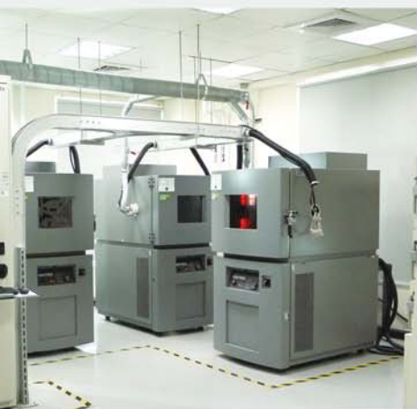
LED壽命測試實驗室。(圖片提供：德凱宜特股份有限公司)
