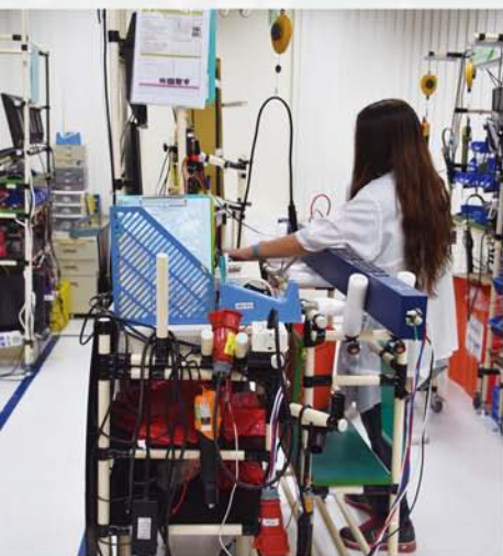
猶如「樂高」的工作模組，可以個別生產也可以組合成大單位。
