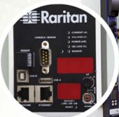
左：智慧PDU能通過機櫃級和設備端的用電監控管理，精確統計設備的耗電量。 右：瑞力登所生產的PDU多達2400多種。
